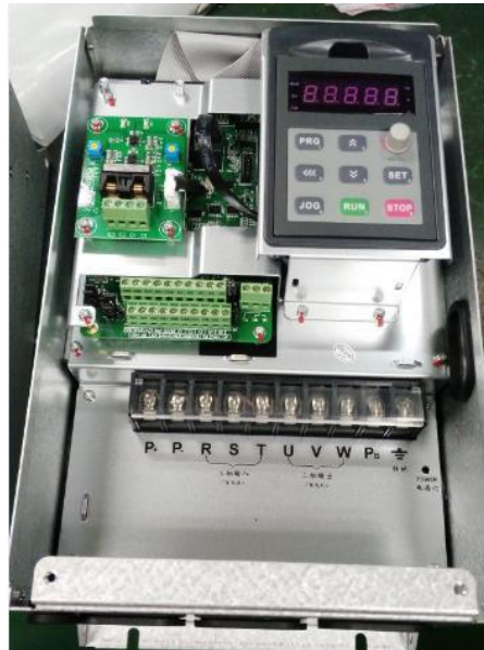
AD800 37kw VFD
